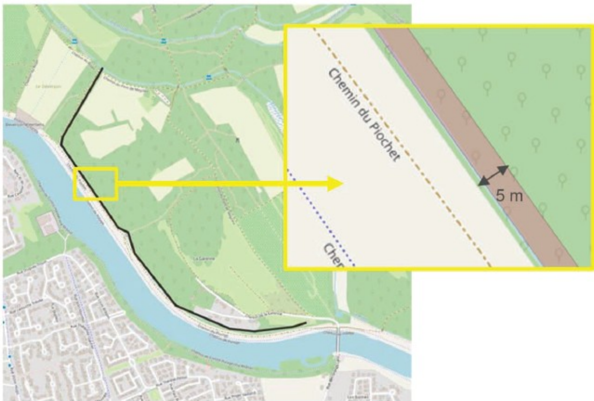
Schéma de repérage des zones de débroussaillage sélectif sur le secteur C
