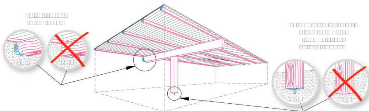
*Solivage et poteau en volume ouvert, constituant des parties d'ouvrages aisément contrôlables et remplaçables*
