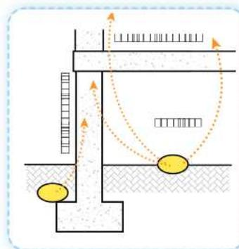
**ATTENTION :** Des matériaux de construction contenant de la cellulose et abandonnés dans les plénums et vides sanitaires obscurs et souvent humides, peuvent constituer une source alimentaire pour les termites et favoriser l'installation d'une colonie sous le bâtiment. Ces espaces doivent par conséquent demeurer propres et vides.
