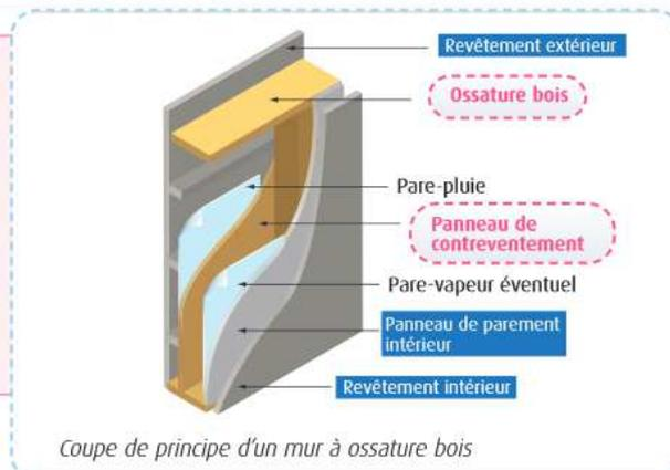
Coupe de principe d'un mur à ossature bois
