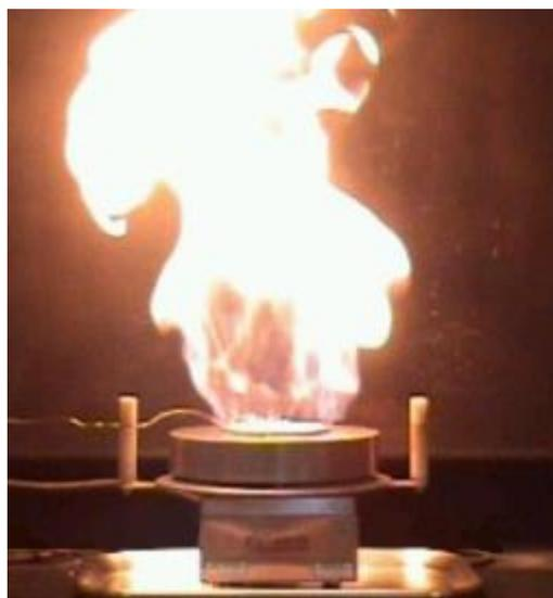
**Appareil de mesure de la température d'auto inflammation en couche**
