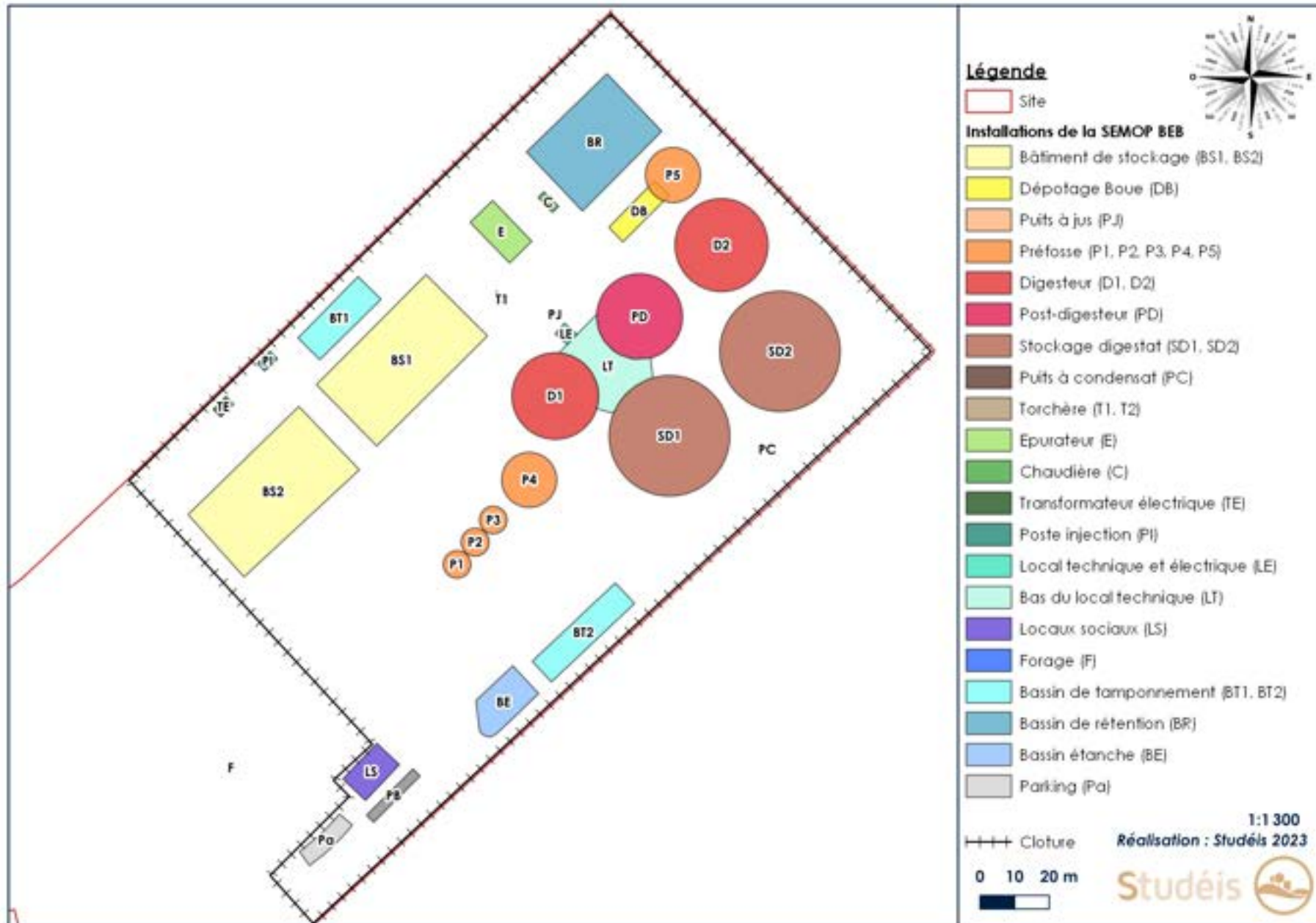
Figure 8. Agencement de l'unité de méthanisation de la SEMOP BIO ENERGIES BEAUJOLAISES - BEB
